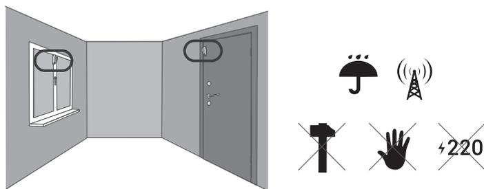
Корпуса сигнализатора и магнита должны быть установлены параллельно, метками навстречу другу, расстояние между ними – не более 6 мм. Сигнализатор следует крепить на неподвижную поверхность (например, на дверной косяк), а магнит – на подвижную (непосредственно на дверь).
