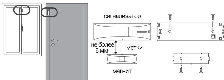
Поднесите магнитный брелок к сигнализатору, к месту, указанному на рисунке (расстояние от брелока до сигнализатора не более 10 мм). 30 секунд сигнализатор будет издавать звуковые сигналы. За это время необходимо закрыть дверь.
